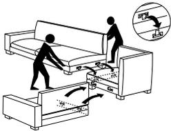
Stellen Sie die Elemente nebeneinander an den richtigen Standort und hängen dann nacheinander die einzelnen Elemente ein. Heben Sie die Elemente an und drücken Sie dann diese herunter, so dass die Elementverbinder ineinander einhaken.
