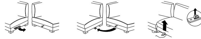
Zum Verbinden klappen Sie den Rasterverbinder in den rechten Winkel zum Möbel und schieben die Elemente dicht zusammen, bis die Verbinderbeschläge hörbar einrasten und evtl. Lücken der Polsterung geschlossen sind. Zum Lösen der Verbindung heben Sie ein Element nach oben aus dem Rasterverbinder heraus und versetzen das Element seitlich.
